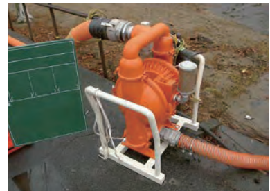
エアハートポンプ外観
