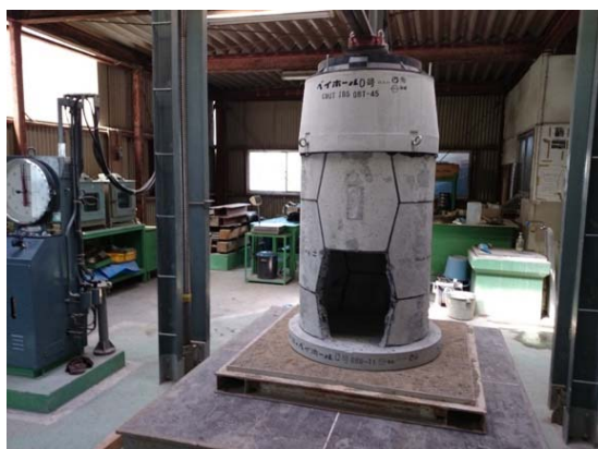
（外側）マンホール（内側）バイセグ
