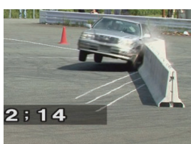
車両後部が防護柵に衝突
